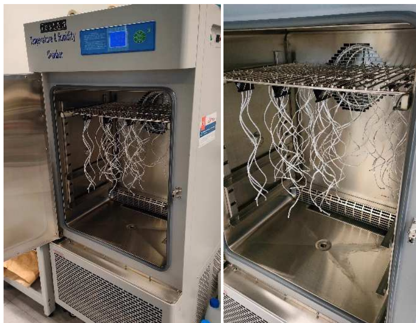
Rysunek 21.1. Komora starzeniowa z umieszczonymi w środku próbkami
