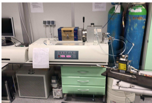
Rysunek 17.5. Aparatura użyta do pomiarów współczynnika Seebecka
