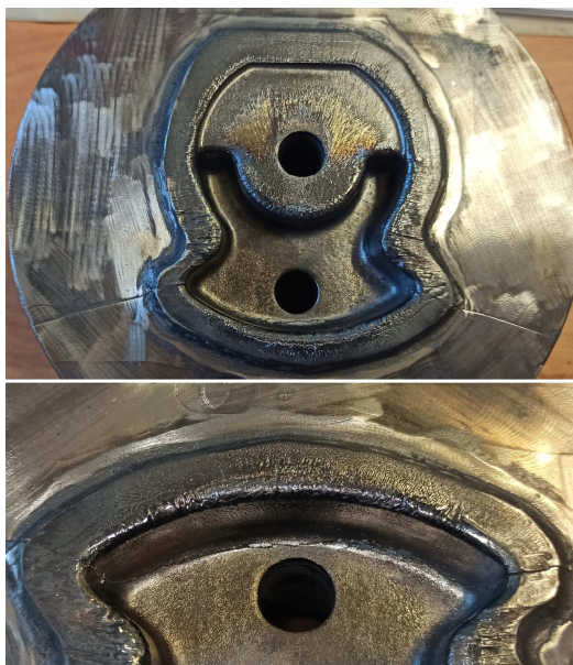
Rysunek 18.1. Zużyta wkładka matrycująca dolna do kucia przeciwciężaru
