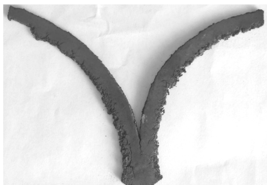
Rysunek 2.7. Materiał po walcowaniu zgodnie z naciskiem podczas prasowania; uprzednio spiekany w temperaturze 1100°C
