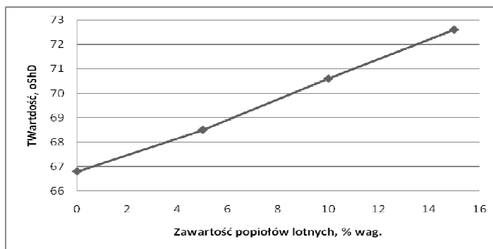
Rysunek 19.2. Twardość PA6 oraz kompozytów na osnowie PA6 z różną zawartością napełniacza z popiołów lotnych
