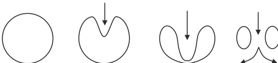
Rys. 8.1. Przebieg implozji pęcherzyka wypełnionego parą od fazy w pełni rozwiniętego pęcherzyka, poprzez tworzenie się mikrostrumienia, aż do powstania pierwszej i drugiej fali uderzeniowej
