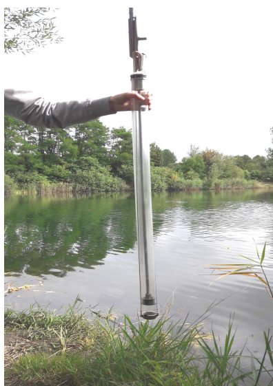
Rys. 2.5. Czerpacz rurowy do pobierania osadów dennych
