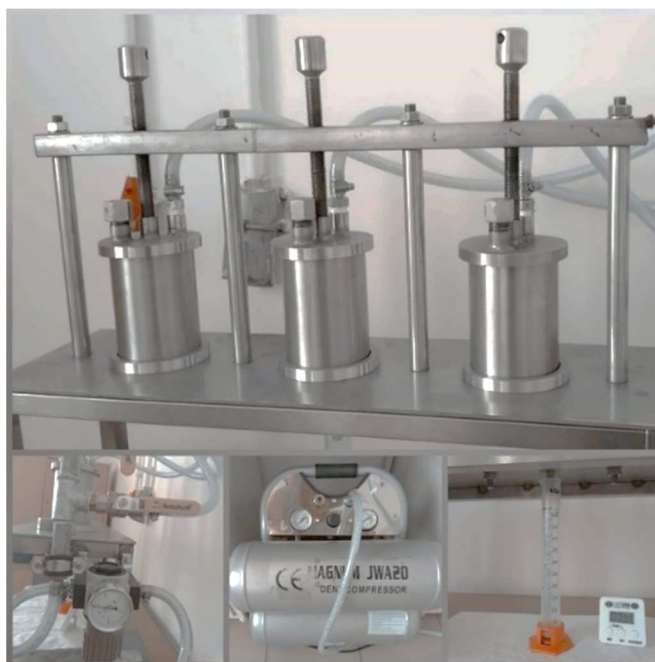
Rys. 1.1. Stanowisko do filtracji ciśnieniowej
