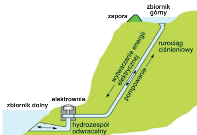
Rys. 2.8. Schemat działania elektrowni szczytowo-pompowej [7]
