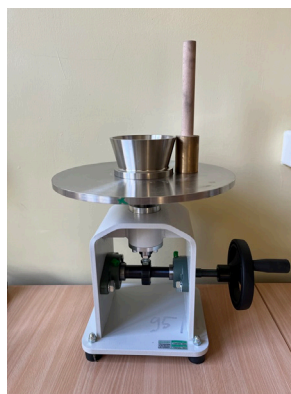
Rysunek 16.4. Stolik wstrząsowy użyty do badania rozplwyu zaprawy
