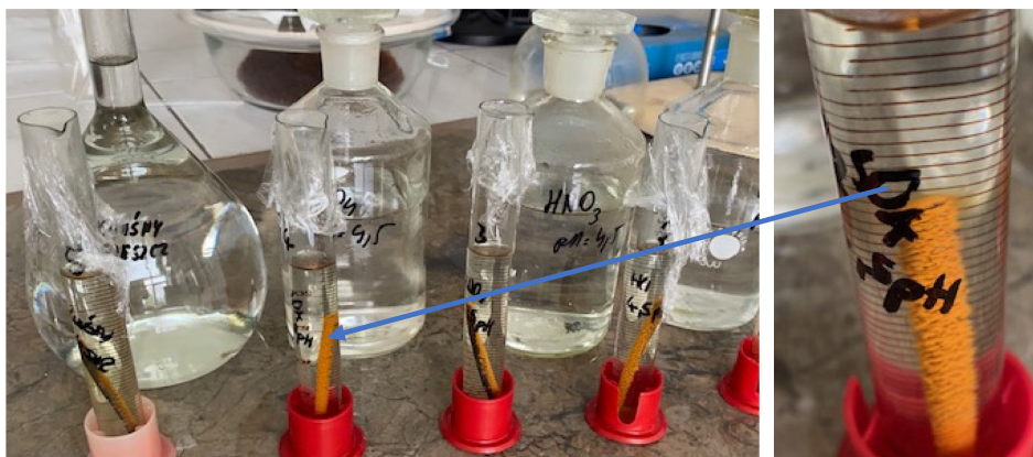
Rysunek 15.1. Wygląd badanych próbek stalowych podczas oddziaływania ze środowiskiem korozyjnym
