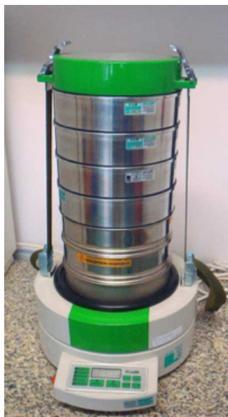
Rysunek 16.5. Zestaw sit użytych do badania składu ziarnowego kruszywa naturalnego i recyklingowego
