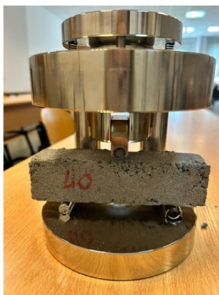
Rysunek 16.2. Wkładka do prasy hydraulicznej służąca do badania wytrzymałości na zginanie
