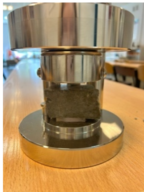
Rysunek 16.3. Wkładka do prasy hydraulicznej służąca do badania wytrzymałości na ściskanie
