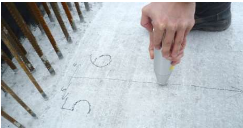
Fot. 1.10. Pomiary wykonane za pomocą sklerometru (młotka Schmidta)
