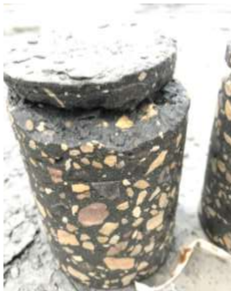
Fot. 4.3. Widok próbki pobranej z płyty fundamentowej budynku mieszkalnego
