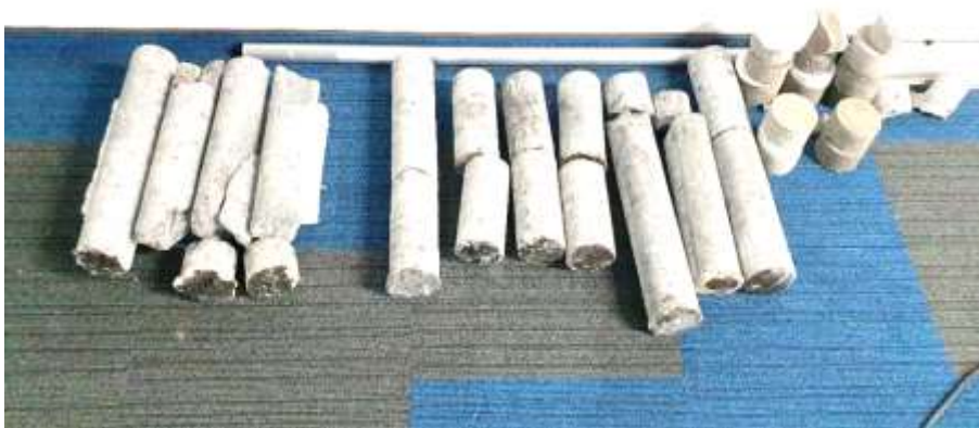
Fot. 2.6. Pobrane próbki betonu
