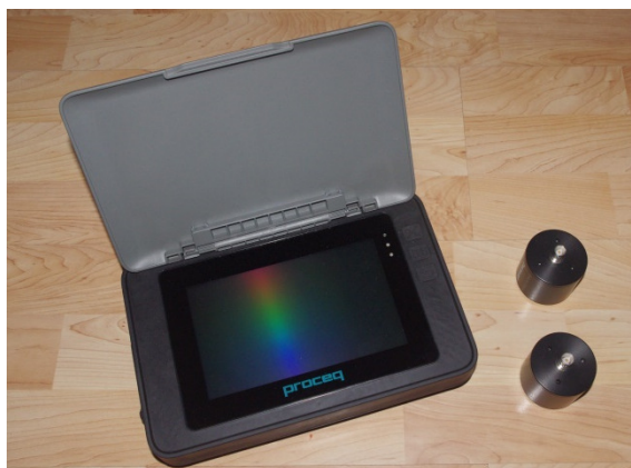
Rys. 2.6. Betonoskop Pundit PL-200 z przetwornikami o częstotliwości 54 kHz
